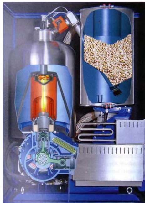
Querschnitt durch eine „Sunmachine Pellet“: Aus dem Vorratsbehälter werden die Pellets auf den Rost befördert und erhitzt. Das dabei entstehende Holzgas wird gezündet und treibt den Stirlingmotor an, der über einen Generator Strom erzeugt.
