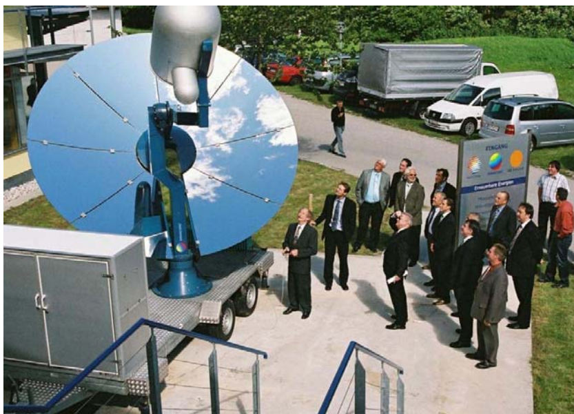
Vorstellung der Sunmachine-Solar mit Parabolspiegel von vier Meter Durchmesser
